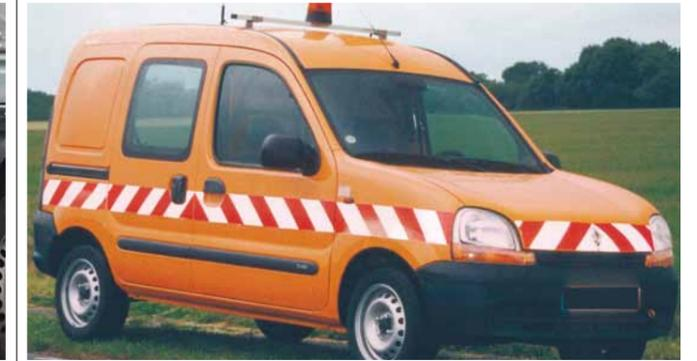
Fahrzeuge, die beim Bau, der Instandhaltung, der Müllabfuhr oder der Reinigung von Straßen eingesetzt werden, müssen durch rot-weiß reflektierende Warnmarkierung, Folie Typ 2 (DIN 30 710) gekennzeichnet sein (§ 35 StVO, Abs. 6).
