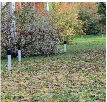
Stahl-Sperrpfosten zur objektseitigen Kennzeichnung von Aufstell- und Bewegungsflächen für Feuerwehrfahrzeuge.
